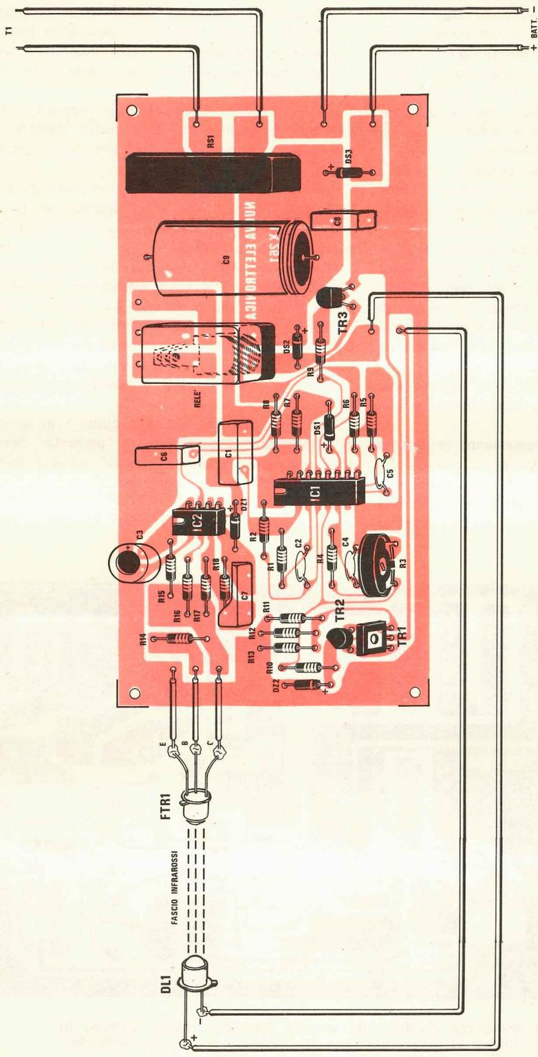
Fig. 4 Schema pratico di montaggio dell'antifurto a raggi infrarossi. I due fili a destra contraddistinti dalla sigla T1, si dovranno collegare alla tensione di 9 volt alternati che preleveremo dal secondario del trasformatore T1, mentre gli altri due fili, contraddistinti dalla scritta «BATT.», ad un accumulatore da 12 volt, rispettando ovviamente la polarità.
