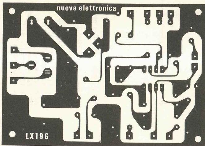
Fig. 3 Disegno del circuito stampato a grandezza naturale. Questo circuito viene fornito in fibra di vetro, già forato e completo di disegno serigrafico.
