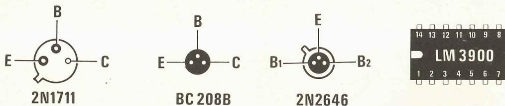
Fig. 3 Disposizione dei terminali dei transistor e dell'unigiunzione visti dal lato che fuoriescono dal corpo. L'integrato LM.3900 è visto invece da sopra.
