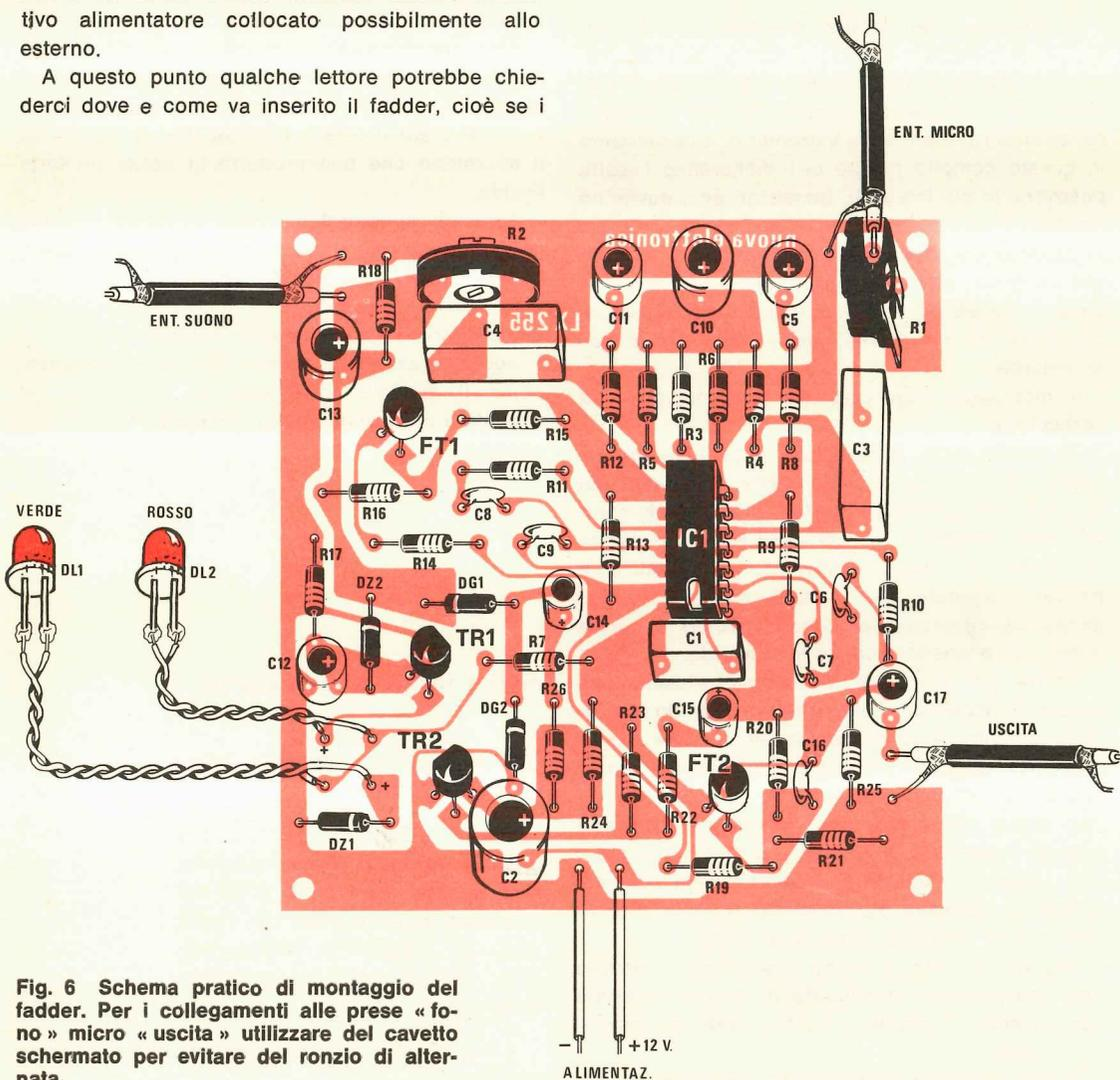
**Fig. 6** Schema pratico di montaggio del fadder. Per i collegamenti alle prese « fono » micro « uscita » utilizzare del cavetto schermato per evitare del ronzio di alternata.
