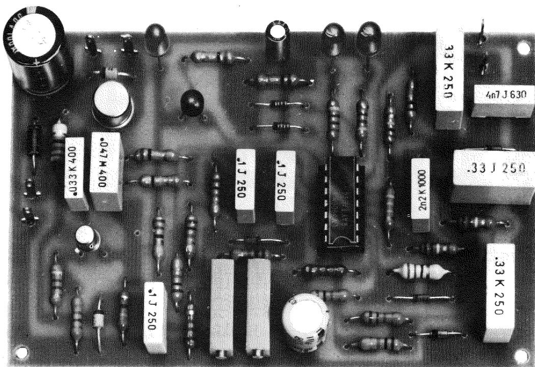
Ecco la foto di uno dei nostri prototipi di « salvamulte » da noi montati per il collaudo. Si nota in basso i due trimmer multigiri per la taratura, ed in alto i diodi led che dovremo fissare sul pannello frontale del mobile.
