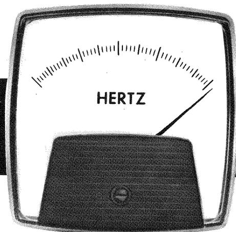
La differenza esistente fra un frequenzimetro **digitale** ed uno **analogico** è facilmente intuibile: il primo infatti ci indica la frequenza facendola apparire su delle nixie o dei display numerici, il secondo invece utilizza per questo scopo la lancetta di uno strumento a bobina mobile.
