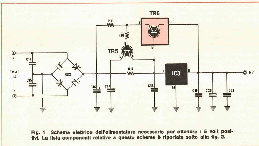
Fig. 1 Schema elettrico dell'alimentatore necessario per ottenere i 5 volt positivi. La lista componenti relative a questo schema è riportata sotto alla fig. 2.
