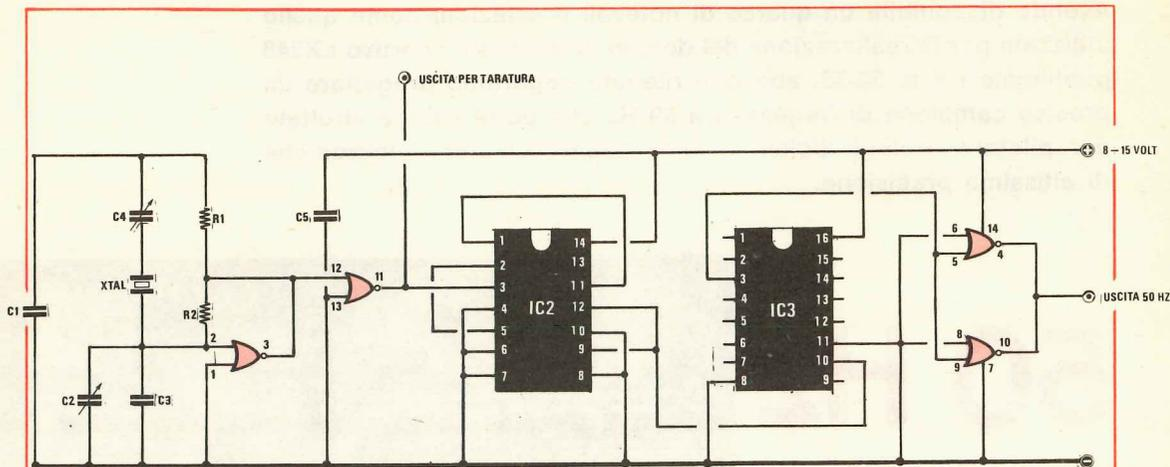
Fig. 1 Schema elettrico.
