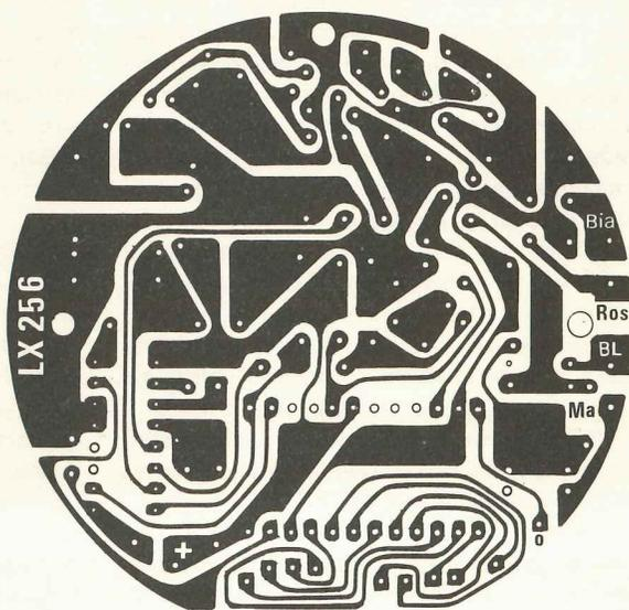
Fig. 4 In basso = Schema pratico di montaggio del circuito. I fili che escono da sopra, andranno tutti a collegarsi al circuito stampato della tastiera, quelli sulla destra invece alla morsettiere del vostro telefono rispettando i colori da noi riportati. Nota sul circuito stampato è presente un ponticello in filo nello spazio che intercorre tra il condensatore C1 e C2.
