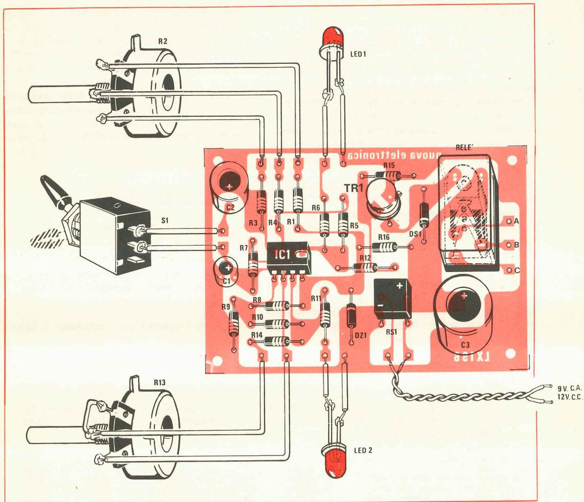
**Fig. 4** Schema pratico di montaggio del temporizzatore ciclico. Per alimentare il circuito si può prelevare da un secondario di un trasformatore 9 volt alternati, oppure 12 volt continui da un accumulatore o pila.
