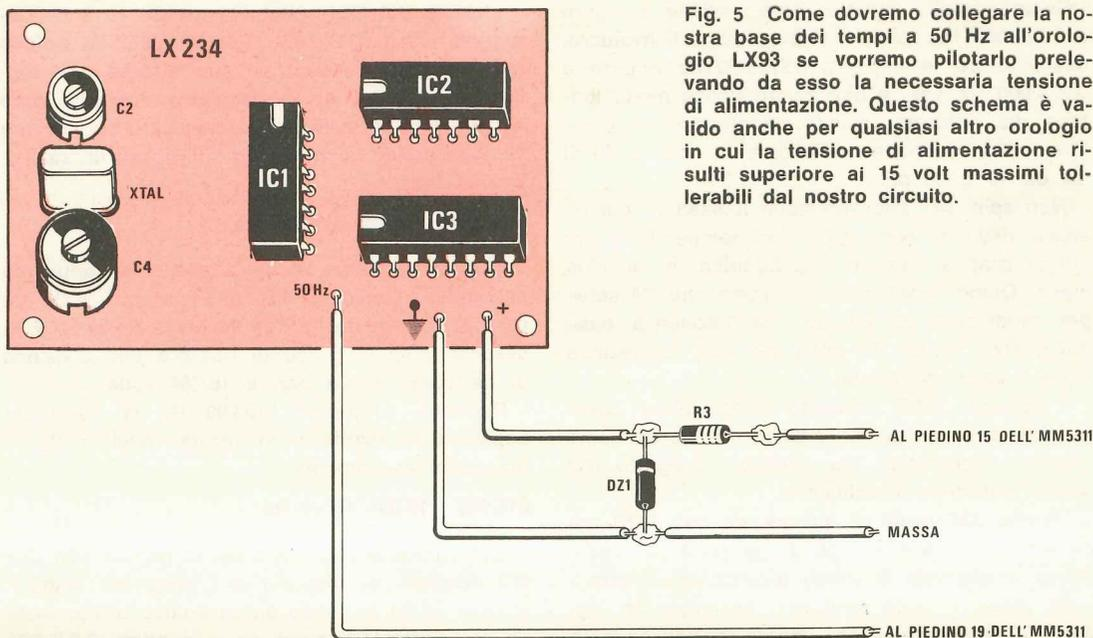
Fig. 5 Come dovremo collegare la nostra base dei tempi a 50 Hz all'orologio LX93 se vorremo pilotarlo prelevando da esso la necessaria tensione di alimentazione. Questo schema è valido anche per qualsiasi altro orologio in cui la tensione di alimentazione risulti superiore ai 15 volt massimi tollerabili dal nostro circuito.
