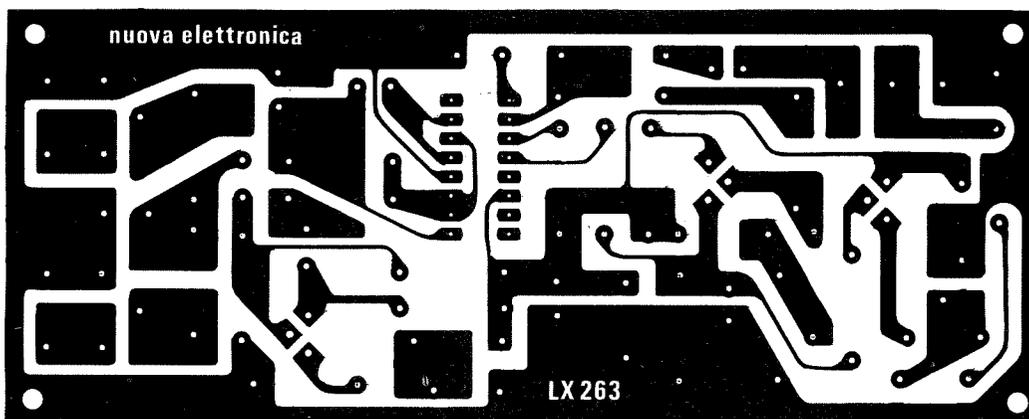
**Fig. 2** Disegno a grandezza naturale del circuito stampato. Si raccomanda di racchiudere una volta montato il compressore entro un mobile metallico (che noi forniamo) per evitare ronzii di alternata.
