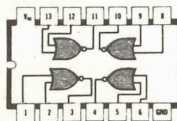
Fig. 4 Connessione ai terminali dello zoccolo dei quattro nor c-mos contenuti nell'interno dell'integrato CD.4001.
