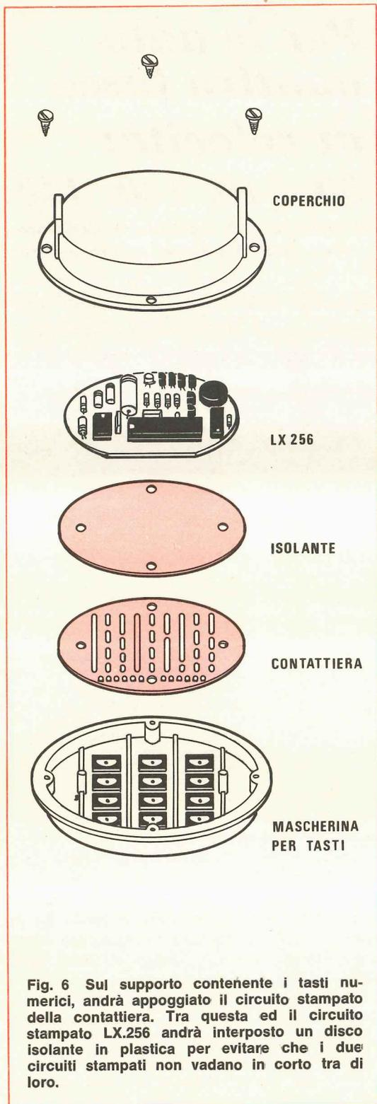
**Fig. 6** Sul supporto contenente i tasti numerici, andrà appoggiato il circuito stampato della contattiera. Tra questa ed il circuito stampato LX.256 andrà interposto un disco isolante in plastica per evitare che i due circuiti stampati non vadano in corto tra di loro.
