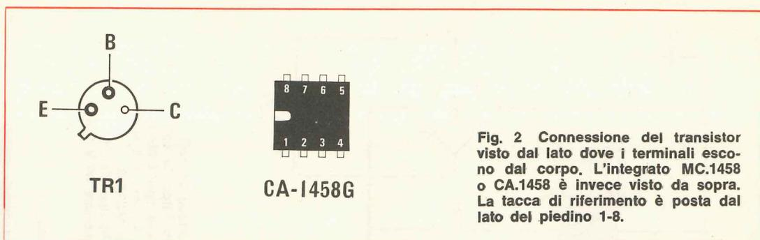
Fig. 2 Connessione del transistor visto dal lato dove i terminali escono dal corpo. L'integrato MC.1458 o CA.1458 è invece visto da sopra. La tacca di riferimento è posta dal lato del piedino 1-8.
