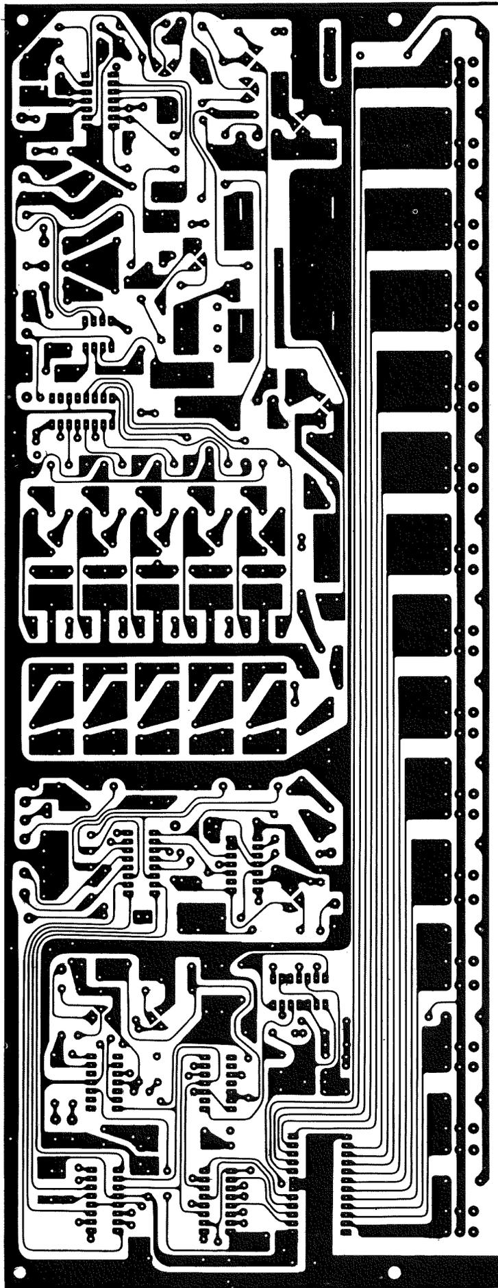
Fig. 5 Lato inferiore del circuito stampato non riportato a grandezza naturale. Questo circuito a doppia faccia in fibra di vetro, viene fornito al lettore già forato e protetto da una speciale vernice per evitare al rame di ossidarsi. Si raccomanda di stagnare, prima di inserire i componenti, le piste superiori con quelle inferiori del circuito stampato come ampiamente consigliato nell'articolo.
