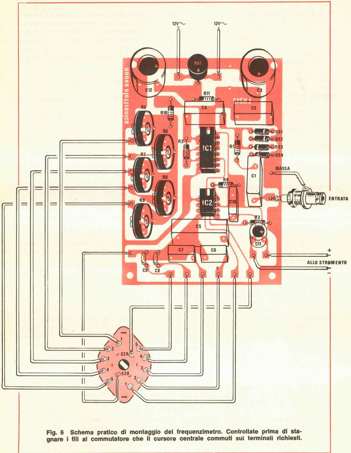
**Fig. 6** Schema pratico di montaggio del frequenzimetro. Controllate prima di staginare i fili al commutatore che il cursore centrale commuti sui terminali richiesti.
