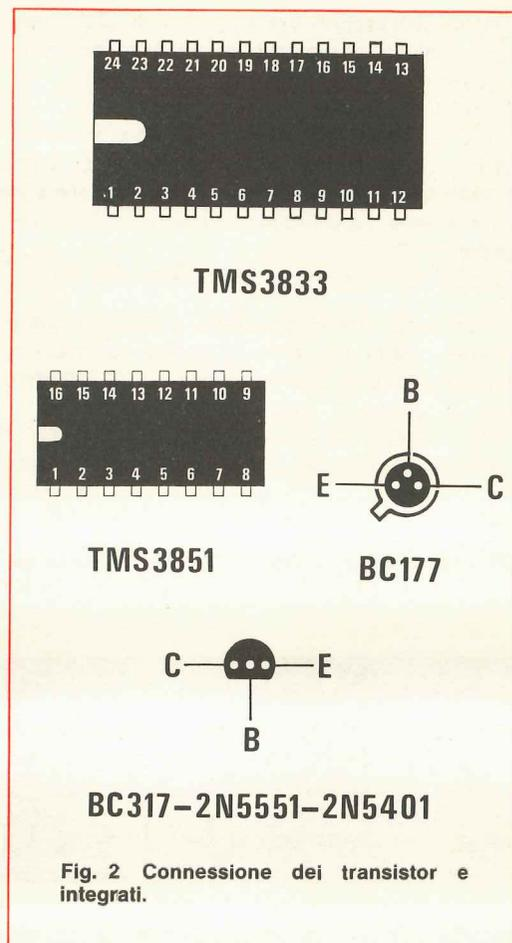
Fig. 2 Connessione dei transistor e integrati.
