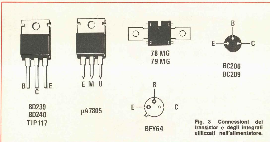
Fig. 3 Connessioni dei transistor e degli integrati utilizzati nell'alimentatore.
