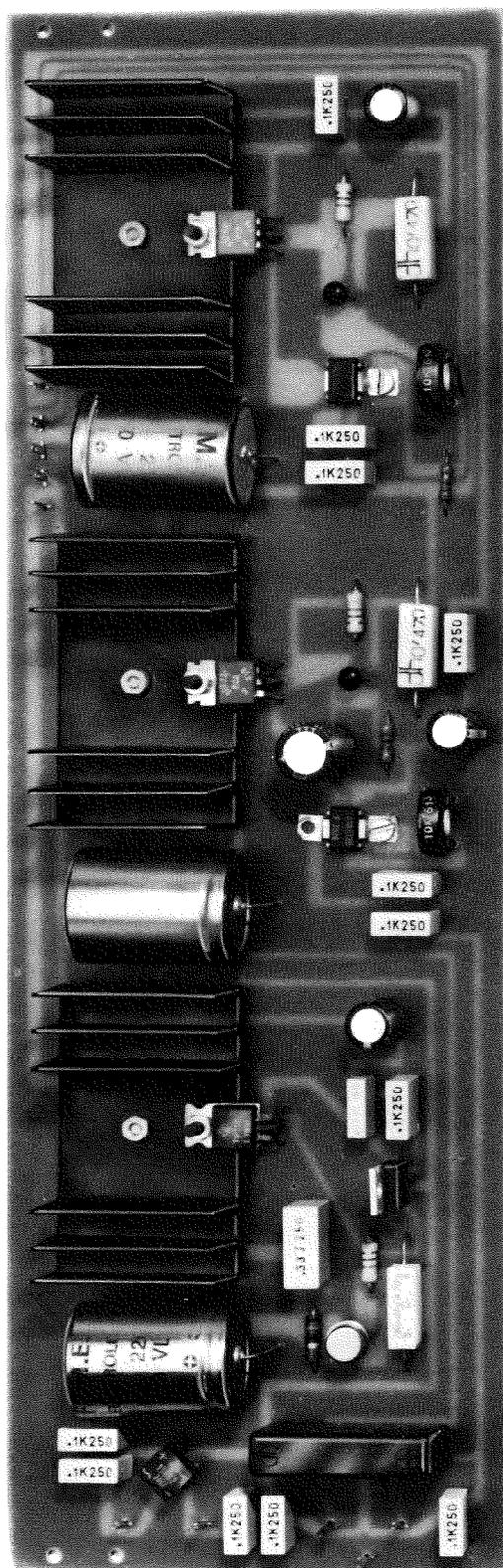
Come apparirà, a montaggio ultimato, l'alimentatore per la vostra « batteria elettronica ». Si notino, in questa foto, i tre transistor di potenza applicati ciascuno sulla propria aletta di raffreddamento.
