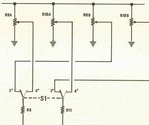
Fig. 5 È possibile adattare il nostro circuito per altre due velocità supplementare, o adottarlo per la 3ª e 4ª marcia sostituendo il deviatore S1 con un doppio deviatore e aggiungendo altre due trimmer multigiri (vedi R8B e R10B) di identico valore a R8 e R10.
